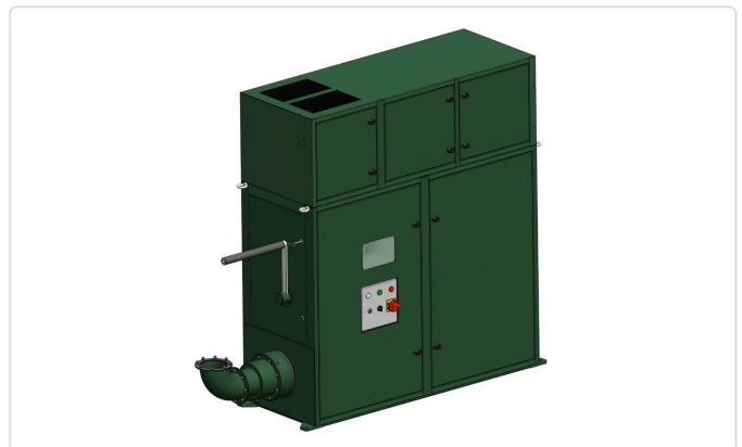
Filtračno-ventilačná sústava z našej výroby — filtrová časť, ventilátor a meranie.
